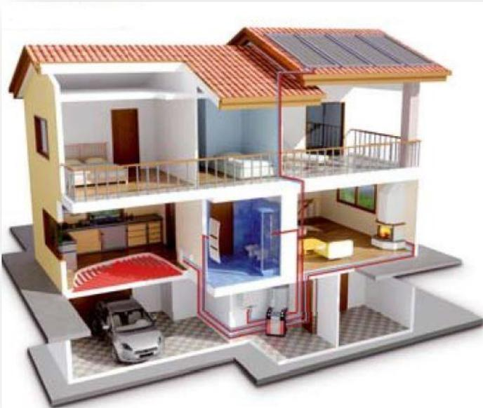
L' impianto idro-sanitario comprende tutte le tubazioni ed accessori per la realizzazione di bagni e cucine. Realizzato con tubazioni in multistrato opportunamente rivestite e coibentate, poste nelle contro-pareti o sotto pavimento. Per ogni bagno è prevista una scatola di derivazione completa di rubinetti d'intercettazione per ogni singolo apparecchio.
