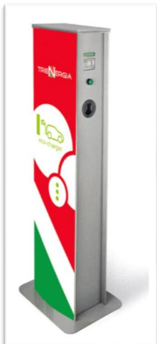
Colonnina in lamiera d'acciaio verniciata con 1 o 2 prese con blocco Tipo 2 1P+N+T 32A 230Vac 7kW o 3P+N+T 32A 400Vac 22kW (dipende dal modello)
