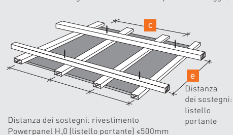
Rivestimenti soffitti con sottostruttura in legno fissata direttamente
