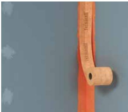
Annegare nella guaina liquida sigillante **fermacell** ancora umida il nastro elastico sigillante **fermacell** e ricoprire direttamente con la stessa guaina sigillante; tempo di asciugatura: almeno 1 ora
