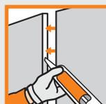
FERMACELL Colla per fughe incolla le lastre e ottura le fughe. Anche nel caso di fughe trasversali senza la posa di sottostutture aggiuntive si ottiene la completa stabilità delle lastre.
