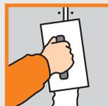
Con FERMACELL Stucco per giunti non è necessario applicare nastri di armatura (carta microforata, rete adesiva in fibra di vetro o nastro in velovetrol).
