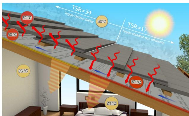
*Schema rappresentativo del funzionamento della superficie Optima Reflex rispetto ad una copertura tradizionale.*
