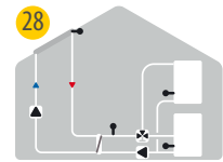
28 Solare con scambiatore e 2 accumuli
