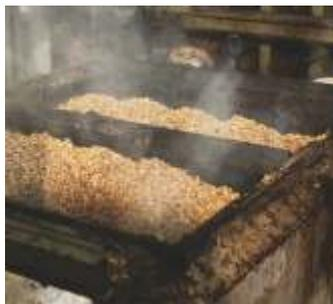
La tostatura e la fusione delle sostanze cerose avviene all'interno di stampi metallici.
