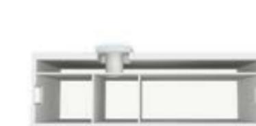
Nella versione per tetti piani, il tunnel solare è completo di captatore esterno con basamento isolato in PVC estruso ad alta densità e cupolino in acrilico trasparente.
