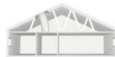
Nella versione per tetti a falda, il tunnel è dotato di captatore esterno in vetro temprato autopulente che si integra perfettamente nel tetto, utilizzando la stessa raccorderia delle finestre per tetti VELUX.
